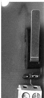
TAMPER SWITCH ON ROBOGUARD
